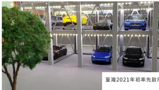
臺灣2021年初率先啟用拼圖型智慧泊車系統
